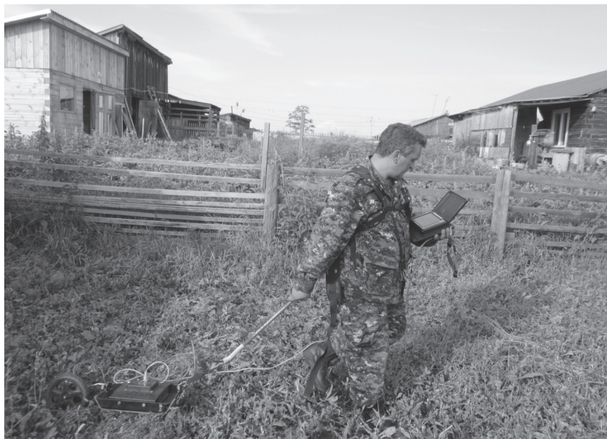
Фото 3. Использование георадара для обнаружения трупa
