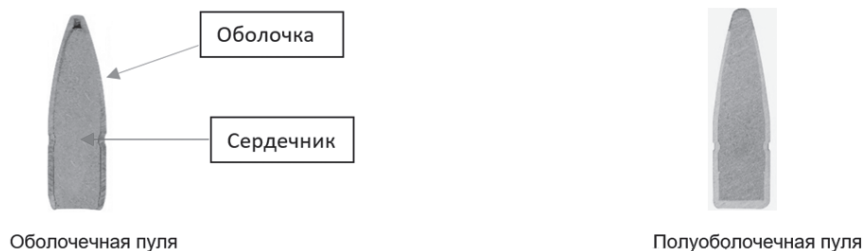
Рис. 8. Оболочечная и полуоболочечная пуля
