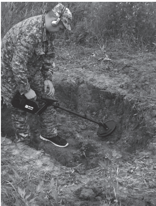
Фото 2. Применение детектора нелинейных переходов
